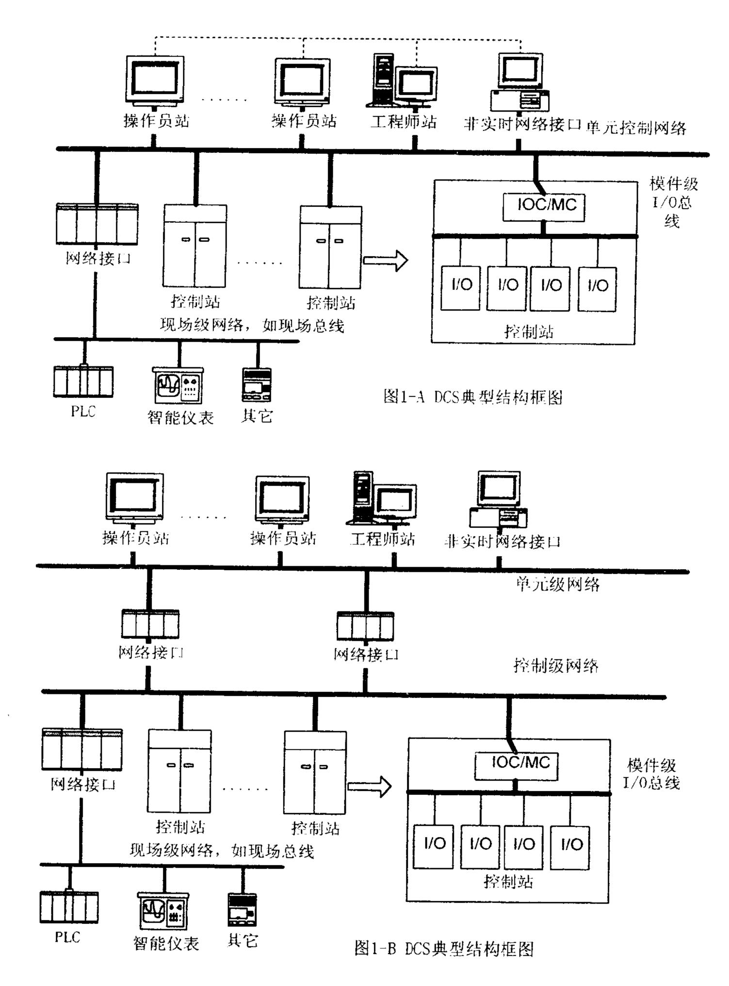
注: ① IOC/MC--I/O总线控制器或者主控制器
