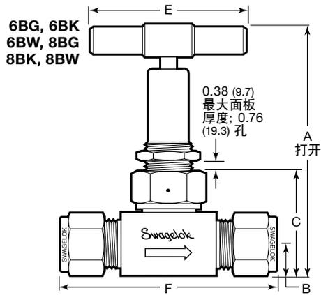
卡套管承插焊和卡套管对焊端接
