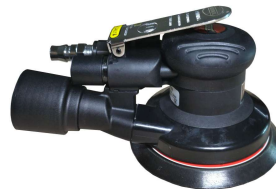
5寸静音型中偏心打磨机 订货号: HR8002V 底盘直径: 125mm/6孔 偏心大小: 5mm 耗气大小: 60升/分钟 空转转速: 12000r. p. m 磨机重量: 0.7公斤
