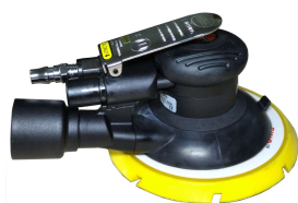
6寸静音型中偏心打磨机 订货号: HR8102V 底盘直径: 150mm/15孔 偏心大小: 5mm 耗气大小: 60升/分钟 空转转速: 12000r. p. m 磨机重量: 0.73公斤
