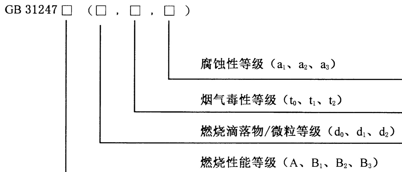
示例:GB 31247 B<sub>1</sub>-(d<sub>0</sub>, t<sub>1</sub>, a<sub>1</sub>)表示电缆或光缆的燃烧性能等级为B<sub>1</sub>级,燃烧滴落物/微粒等级为d<sub>0</sub>级,烟气毒性等级为t<sub>1</sub>级,腐蚀性等级为a<sub>1</sub>级。
