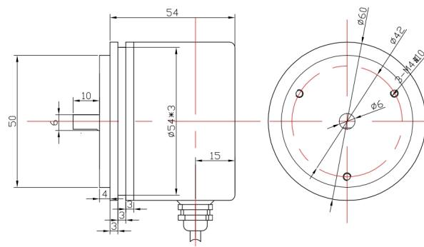
盲孔型/半通孔法兰 ( 电缆输出或插头输出可选 )
