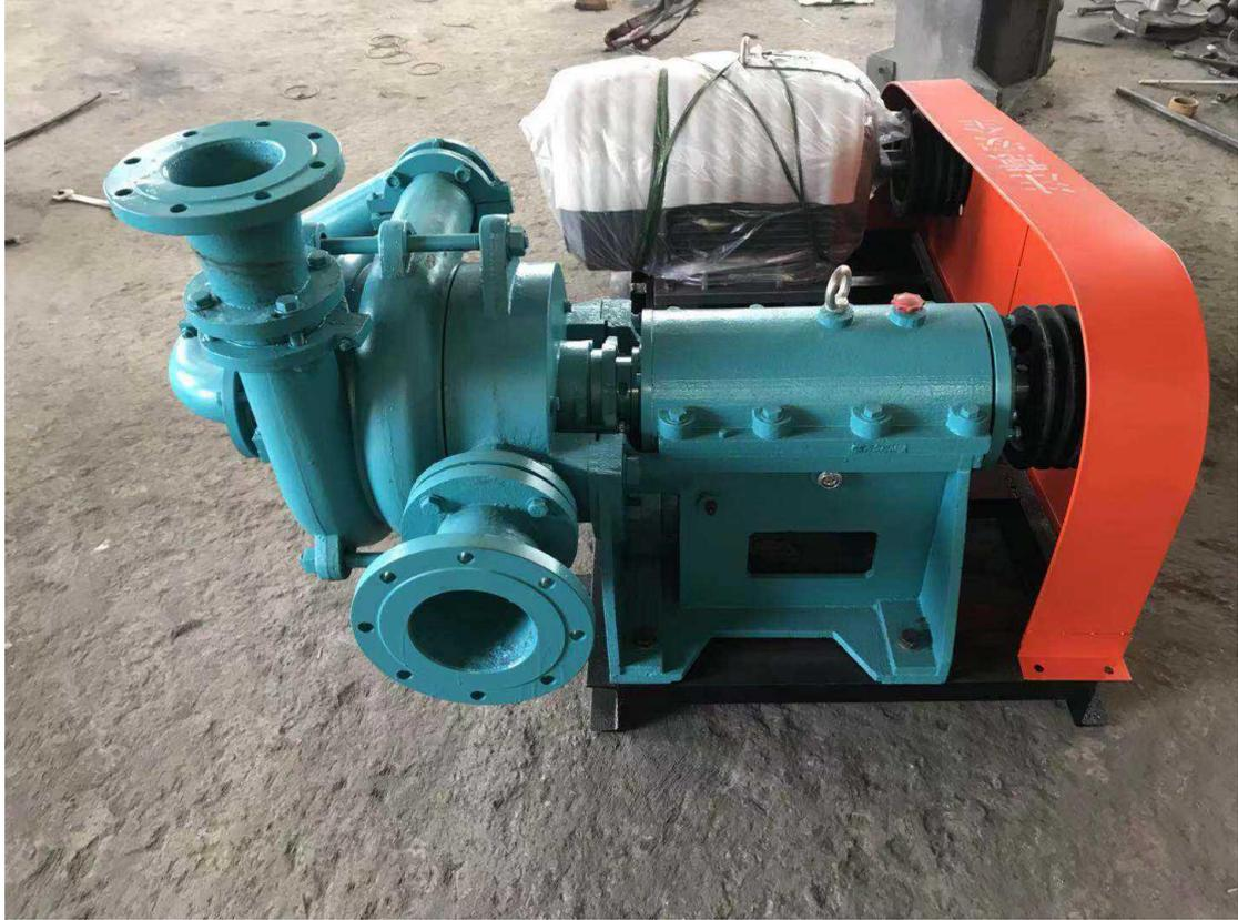
压滤机入料泵采用半开式叶轮，流道宽、通过性好，在输送含有颗粒的浆料时无堵塞，颗粒也不会卡在叶轮和泵体，泵盖之间，从而弥补了一般离心泵所不能达到的效果。压滤机
