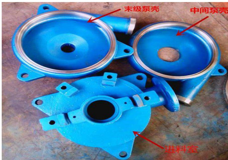
入料泵结构简单、易维修，独特的结构设计，在维修更换叶轮、密封、轴承等易损件时，无需拆卸管道就能完成。
