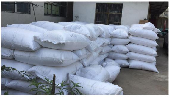
河南山水环保材料有限公司生产的泡沫滤珠是采用进口级聚苯乙烯 颗粒塑料;经过高温多次发泡等特殊工艺制成的白色球状滤料,发泡程
