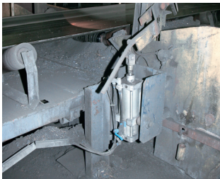
DSBG 用作锤子气缸：大缸径气缸清洁发电厂的传送带，确保通畅地将煤炭送入火炉中。
