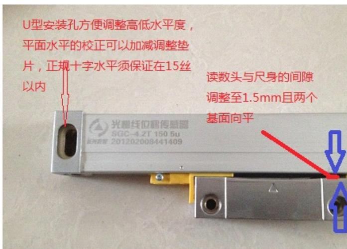
U型安装孔方便调整高低水平度，
