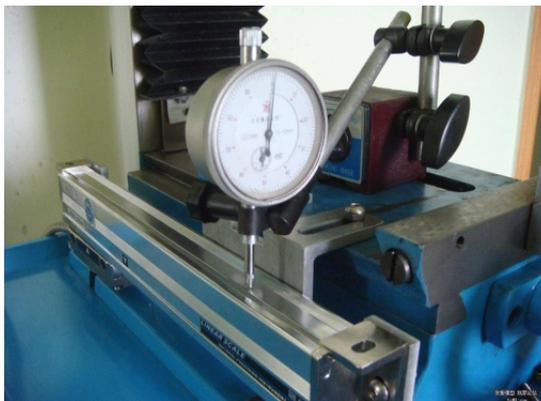
上图是用百分表打的高度水平一定要先打平面再打高度，平面可以用垫片或者铜皮来调节 ↑
