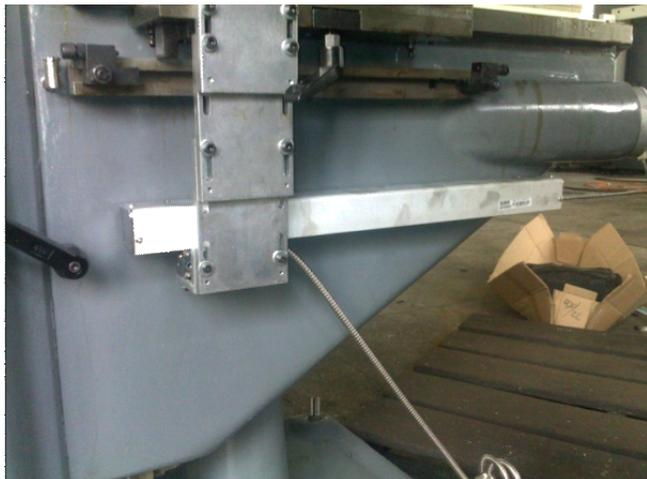
一般铣床的 X 轴平面是比较平的就不用校正平面了可直接校正高低!
